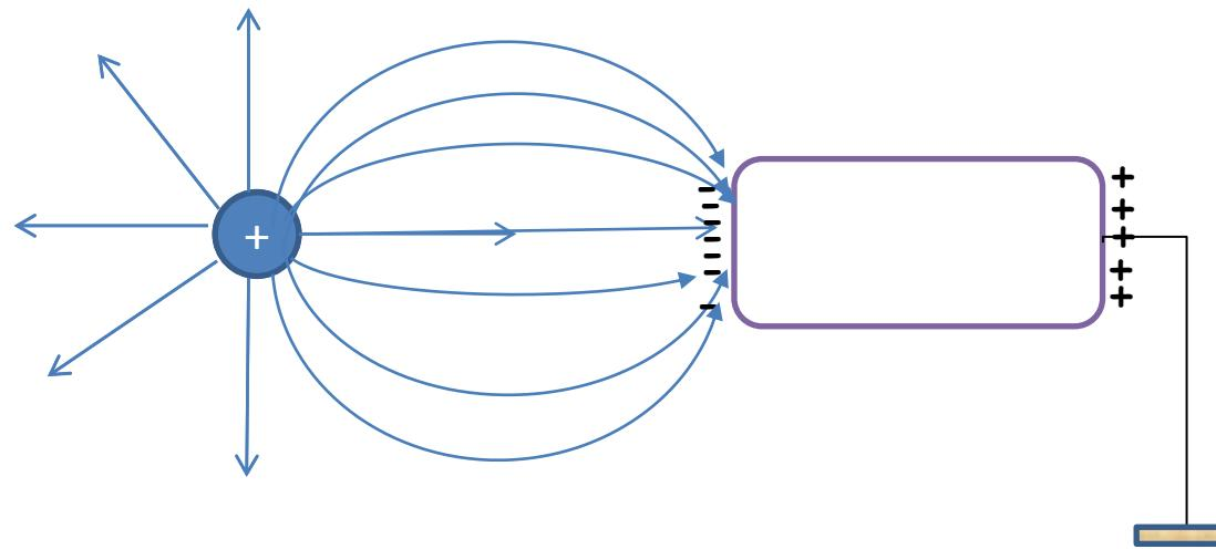
On constate que les charges positives du conducteur passent au sol et il ne reste que les charges négatives qui sont retenues par les plus de la charge.
