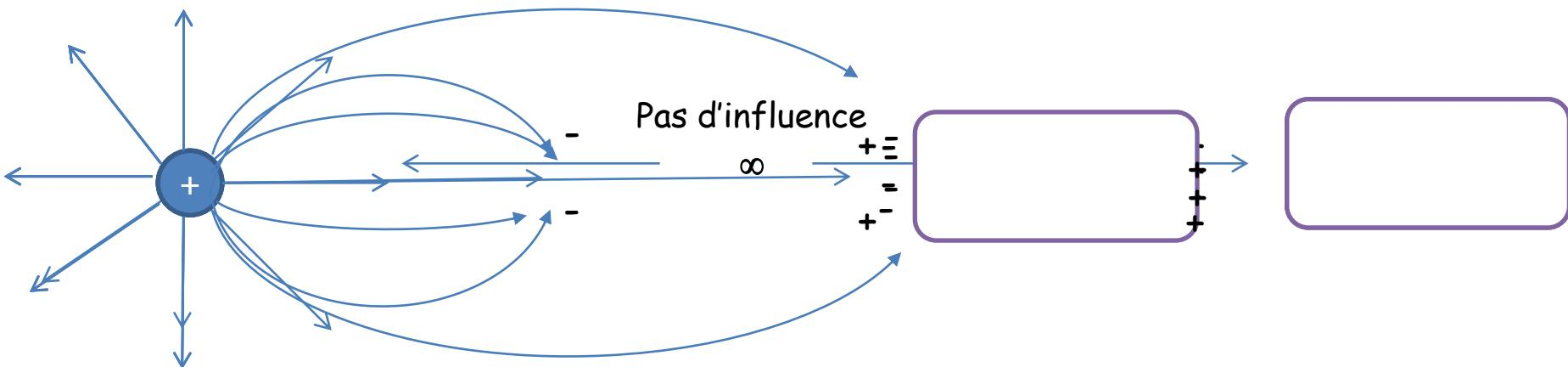
On rapproche le conducteur de la charge, des lignes de champ de la charge arrive sur le conducteur et il y a création d'un champ électrique et donc séparation de charge
