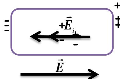
En mettant le conducteur dans un champ électrique ses charges sont soumises à une force et elles se mettent en mouvement
