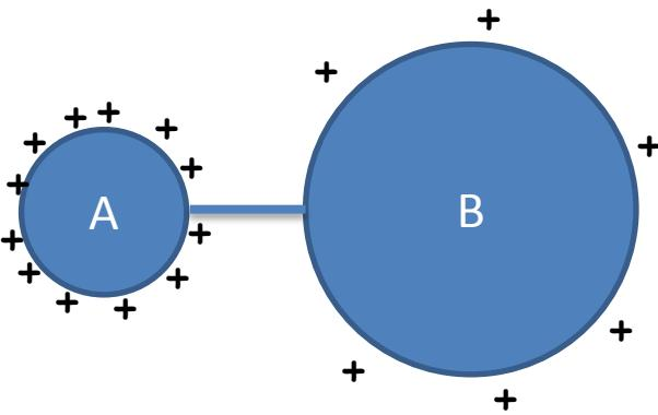
$$\text{Si } R_1 < R_2 \Rightarrow \sigma_1 > \sigma_2$$
